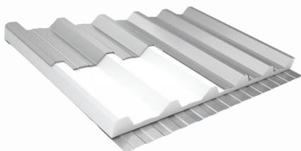
A Telha Forro possui Aço Galvalume na parte superior e núcleo em EPS (Isopor), podendo ser 30 mm ou 50 mm de espessura na parte inferior ela possui Aço Galvalume no formato de Forro. Tendo assim um excelente acabamento, podendo ser pintado ou não. Assim economiza-se com acabamento.
