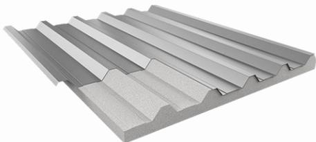
A Telha Semi Sanduíche possui Aço Galvalume na parte superior e núcleo em EPS (Isopor), podendo ser 30 mm ou 50 mm de espessura na parte inferior ela possui um Filme Protetivo, esse modelo é o melhor custo benefício.
